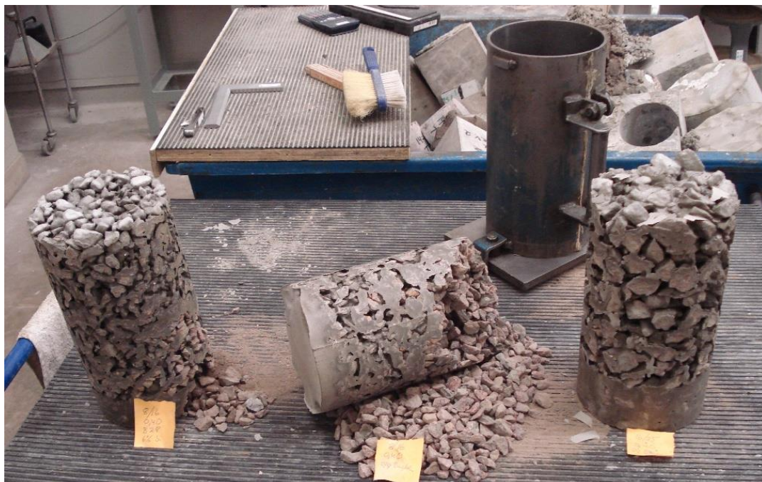
Figur 1. Inledande provning av brukets förmåga att rinna ner och fylla ut stenskelettet i en cylinderform med diameter 100 och höjd 200 mm. Till
