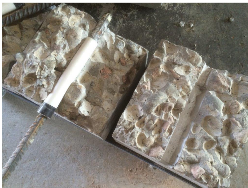
Figur 19. Foto visande spräckt provkropp efter provning av vidhäftning till armeringen. Här kan också observeras en viss bristfällig vidhäftning till stenen som kan ge en försvagad gränsszon.
