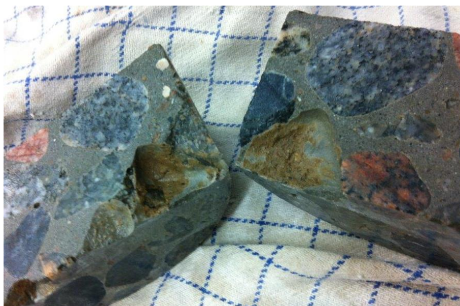
Figur 13. Foto visande provkropp sågad inför mätning av inträngningsdjup av klorider för bestämning av D_{RCM} . På bilden kan ses tecken på bristfällig vidhäftning till stenen.
