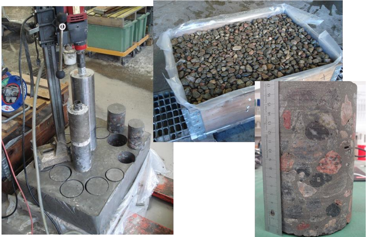
Figur 6. Foton på ½-pallen med packad 16/32 natursten samt utborrningen av cylindrar för tryckhållfasthet, kloridmigration och frysprovning.
