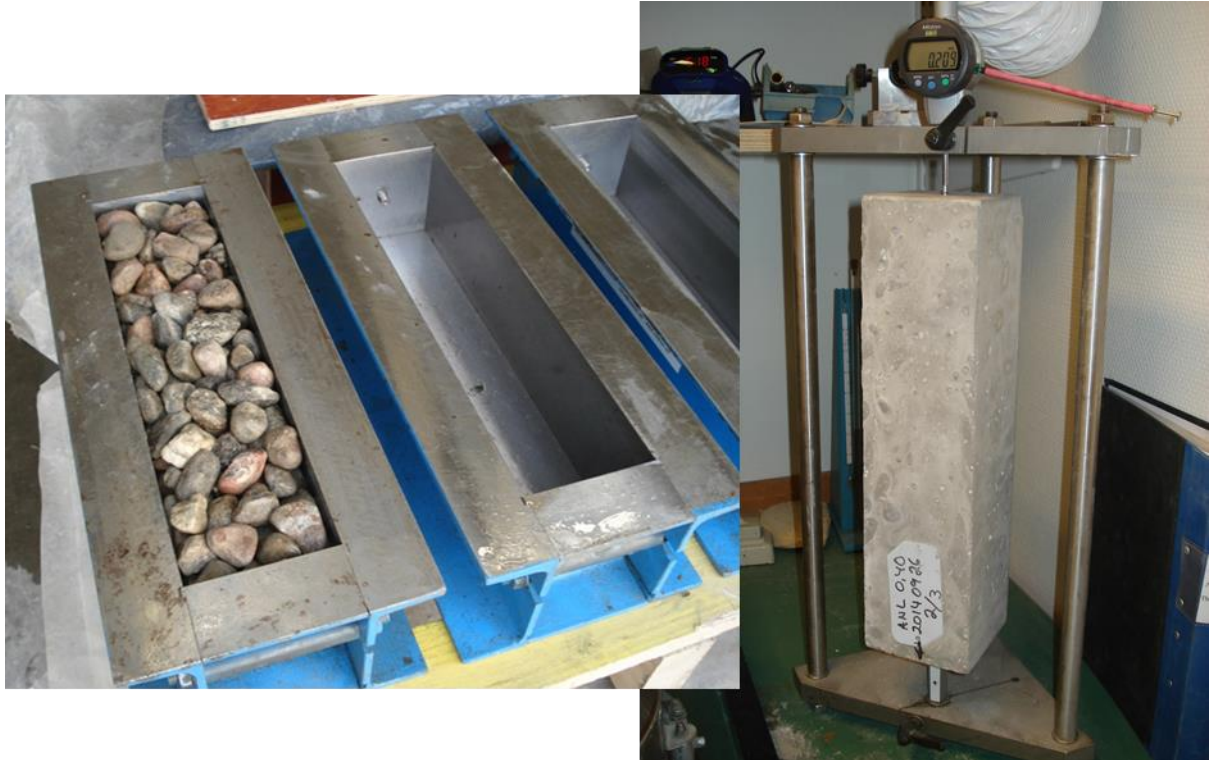
Figur 7. Foton visande provning av krympning enligt SS 137215. Till vänster de tre krympformarna (en packad med 16/32 sten), och till höger mätriggen.
