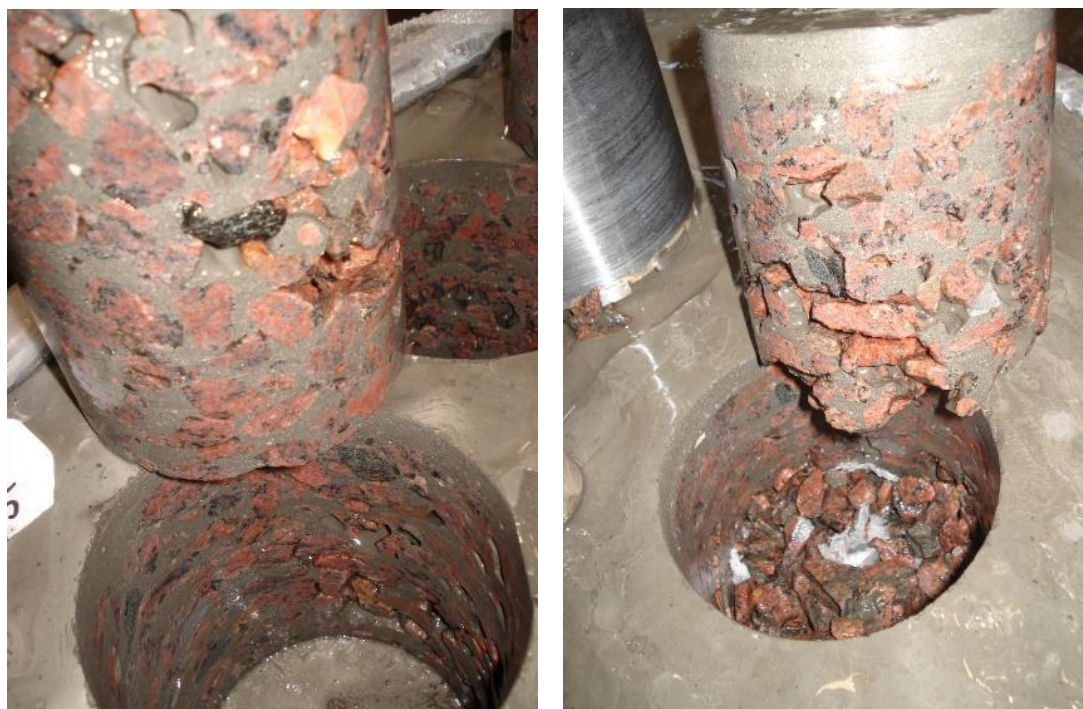
Figur 2. Resultat från den inledande provningen av cementbrukets förmåga att rinna ner och fylla ut ett stenskelett med 16/25 mm Tagene (kross). Utborrade cylindrar visar på bristfällig utfyllnad.
